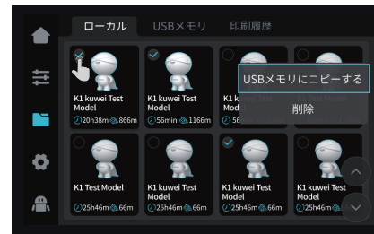
③ モデルの複数選択を押し続け、 且つ、Uディスクにコピーします。
