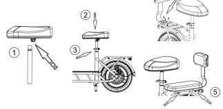
8.① Bauen Sie den Sitz zusammen, ② setzen Sie den Sitz in die Stütze ein, ③ verriegeln Sie den Verschluss; ④ installieren Sie die Rückenlehne, ⑤ montieren Sie das hintere Sitzkissen.
