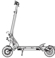
3. Drehen Sie den Drehknopf, um den Faltclip zu verriegeln.
